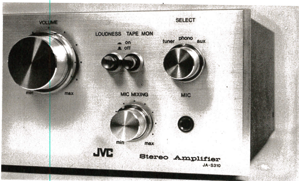
In alto la piastrina in plexiglass con le indicazioni relative alle varie prese (leggibili grazie ad un trucco fotografico). Sotto il radiatore di raffreddamento con i transistori finali. Nella foto grande un particolare del frontale con la presa per microfono e la manopola di missaggio.
